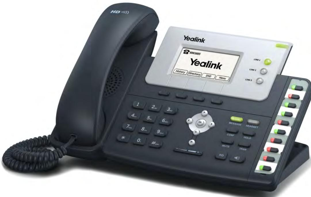
亿联SIP-T26P采用了TI TITAN语音处理芯片, 支持G.722宽频语音编码; 采用带背光图形液晶屏, 达到132x64分辨率, 支持中文显示; 提供3个SIP账号; 提供隐私安全保护; 话机自带3方语音电话会议, 支持快速拨号, 具备丰富的功能; 话机自带10个可编程键, 并且支持亿联扩展台, 最大可扩展到250个可编程键; 支持耳麦接口, PoE供电; 支持VLAN, OOpen VPN, PnP自动部署; 兼容主流的IP-PBX; 易于安装和使用, 管理方便, 提高办公效率; 适用于主管, 前台, 调度员, 座席员等专业用户用户的需要。
